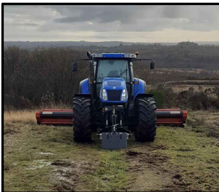
Tracteur 250 chevaux équipé d'un gyrobroyeur forestier de 6 mètres
