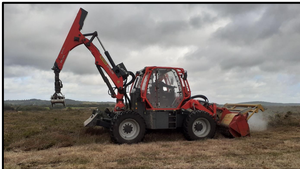
Chaptrack équipé d'un broyeur et d'une pince pour l'épierreage
