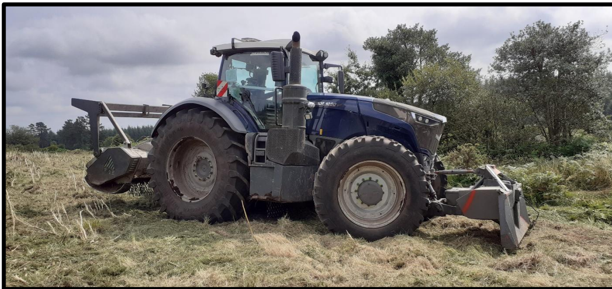
Tracteur 500 chevaux équipé d'un gyrobroyeur forestier de 3 mètres
