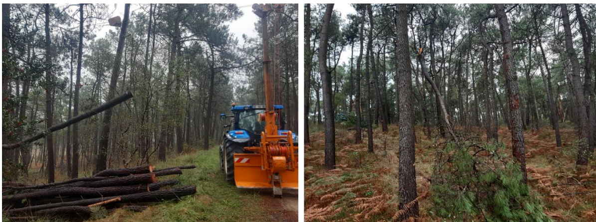
Figure 13: travaux d'abattage de résineux et exportation au câble-mât (tourbière d'Argol)
